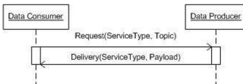
Obrázek 2 – Znázornění jednoduché interakce mezi klientem (Data Consumer) a serverem (Data Producer) na základě požadavku (Request) na doručení odpovědi (Delivery)
